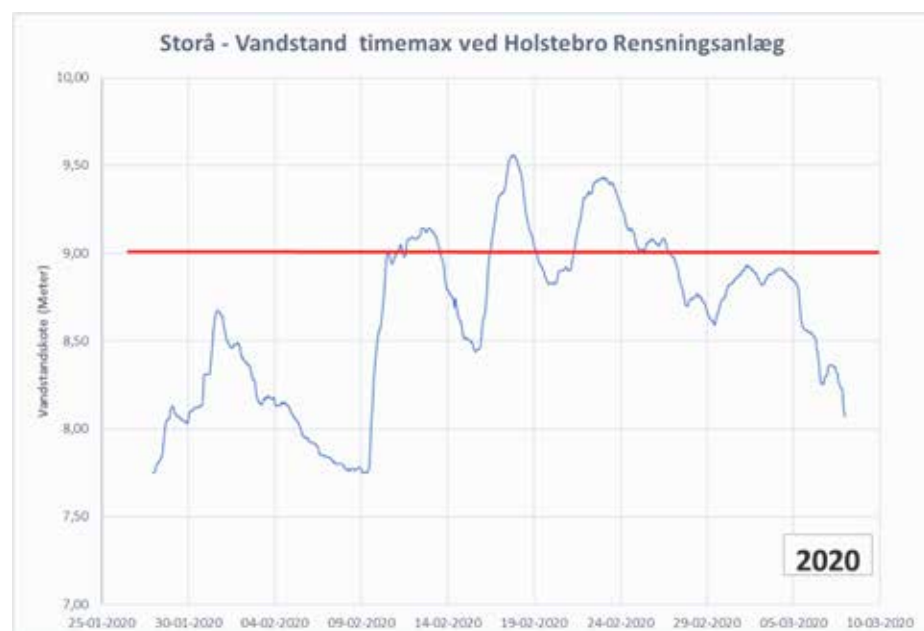
Figur 4: Løsningen for Holstebro er at holde vand tilbage, før det når byen, og lede det videre i et tempo, som åen kan bære uden at oversvømme midtbyen. Det betyder, at der skal parkeres vand i ådalen svarende til volumenet i kurvetoppene, der ligger over den røde linje. Det er beregnet, at denne vandmængde er 4,5 millioner kubikmeter. I diagrammet indikerer den røde linje det kritiske niveau. Den blå kurve er aflæst vandstand
