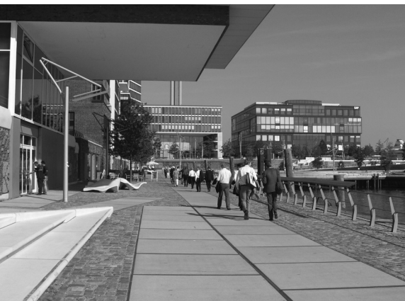
Husene, der grænser op til den eksisterende bymidte, er bygget med udkravning, mens resten af HafenCity er hævet til 8 meter over normalnul. For at sikre kontakten med vandet, er der lavet terrasser, der falder ned mod vandet, og hvor lamper og træer kan tåle jævnlige oversvømmelser. Sport er der også blevet plads til. Fotos: Torsten Bo Jørgensen
